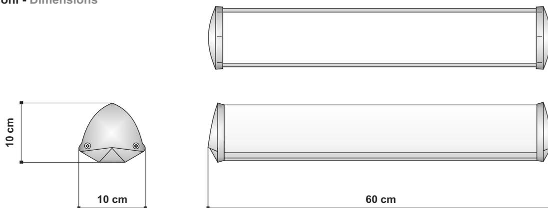
**Schema per il fissaggio a parete - Outline for wall- ceiling fitting**
