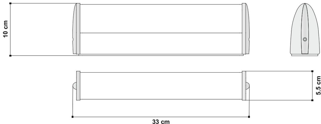
Schema per il fissaggio a muro - Outline for fitting.
