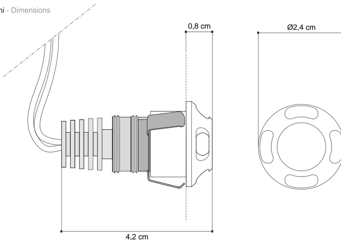
**SOLO COLLEGAMENTO IN SERIE - ONLY SERIAL CONNECTION**
