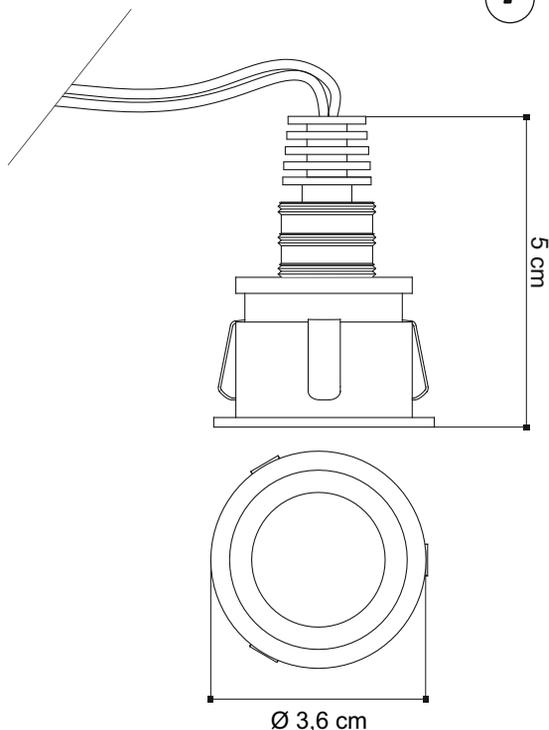
**SOLO COLLEGAMENTO IN SERIE - ONLY SERIAL CONNECTION**
