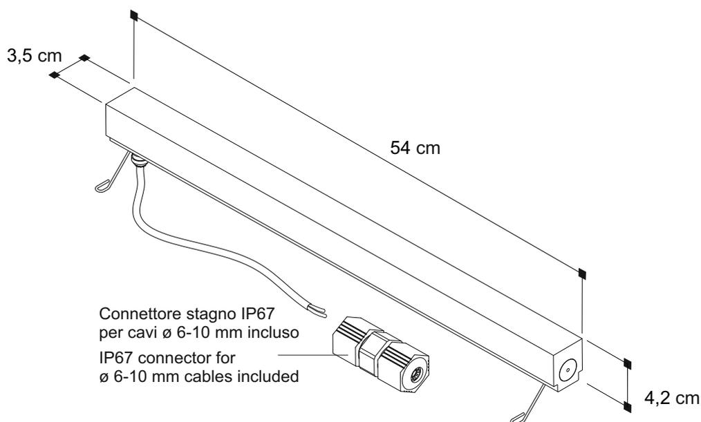
**Montaggio esclusivamente con cassaforma - Mounting only with recessed box**
